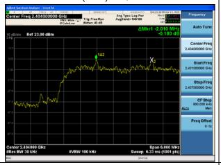
BT 2MHz π/4-DQPSK(4Mbps), Carrier frequency (MHz): 2440
