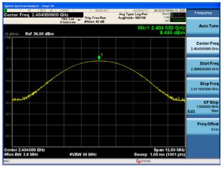
BT 2MHz π/4-DQPSK(4Mbps), Carrier frequency (MHz): 2440
