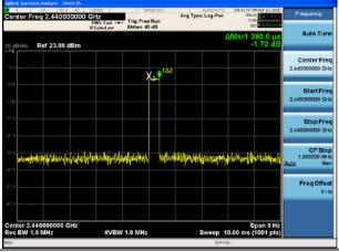
BT 2MHz π/4-DQPSK(4Mbps) CH37, Carrier frequency (MHz): 2478
