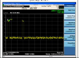
BT 4MHz π/4-DQPSK(8Mbps), Carrier frequency (MHz): 2440
