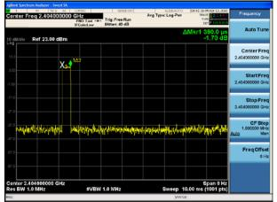
BT 2MHz π/4-DQPSK(4Mbps), Carrier frequency (MHz): 2440
