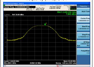
BT 4MHz π/4-DQPSK(8Mbps), Carrier frequency (MHz): 2440
