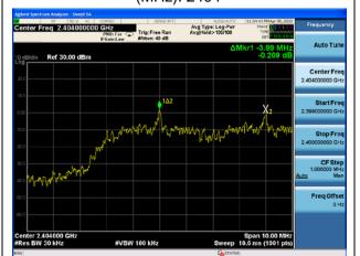
BT 4MHz  $\pi$ /4-DQPSK(8Mbps), Carrier frequency (MHz): 2440
