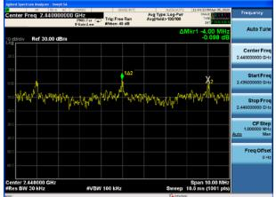
BT 4MHz  $\pi$ /4-DQPSK(8Mbps), Carrier frequency
