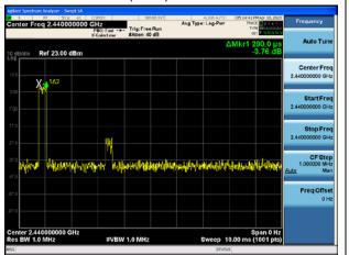
BT 4MHz  $\pi$ /4-DQPSK(8Mbps), Carrier frequency
