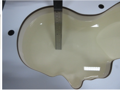
Body(1900MHz~2600 MHz) 15.5cm Head (1900MHz~2600MHz) 15.1cm
