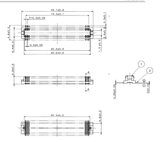
Figure 56: Mechanical dimensions of Hirose DF12 connector
