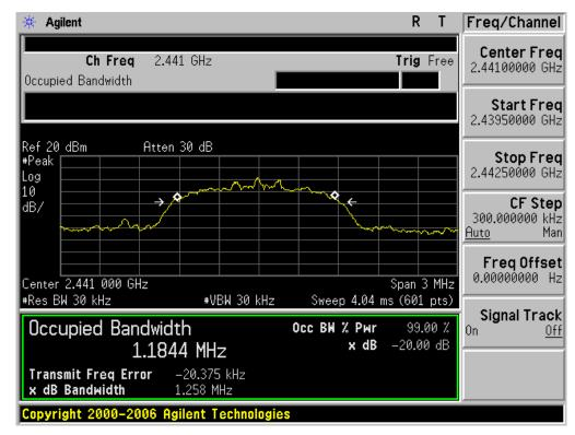
TEST PLOT OF BANDWIDTH FOR HIGH CHANNEL
