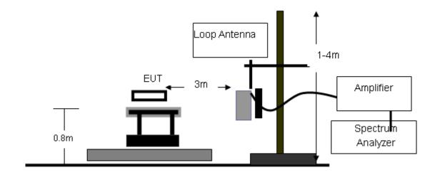
RADIATED EMISSION TEST SETUP 30MHz-1000MHz
