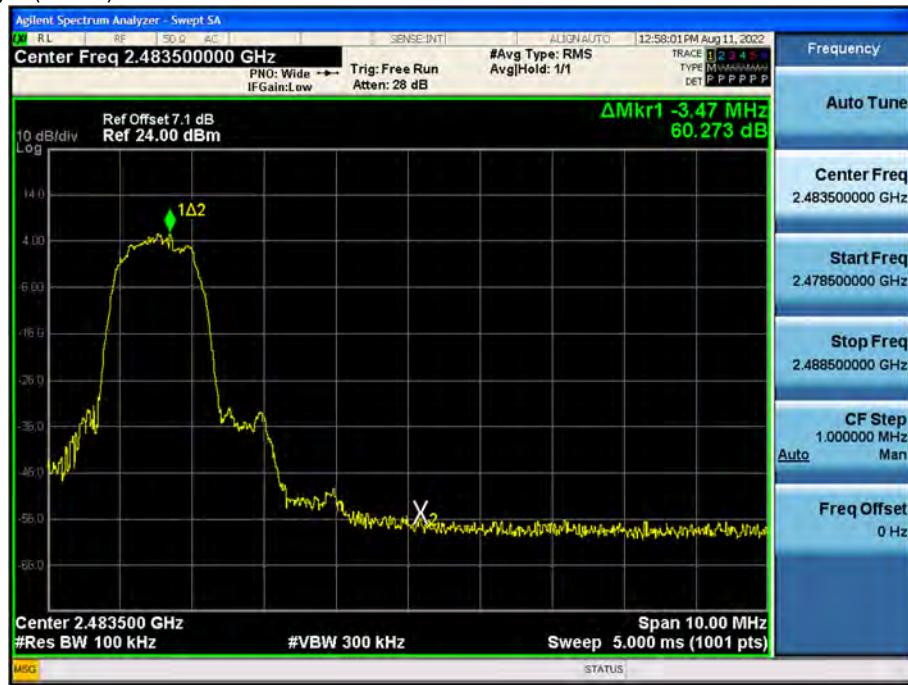
Test Plots without hopping ( $\pi/4$ DQPSK)
