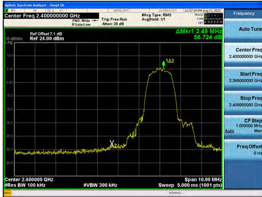
Test Plots without hopping ( $\pi/4$ DQPSK)
