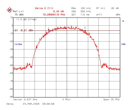
Plot 5.5.5.6 6 dB Bandwidth Frequency: 2462 MHz; Modulation: DQPSK at 2 Mbps
