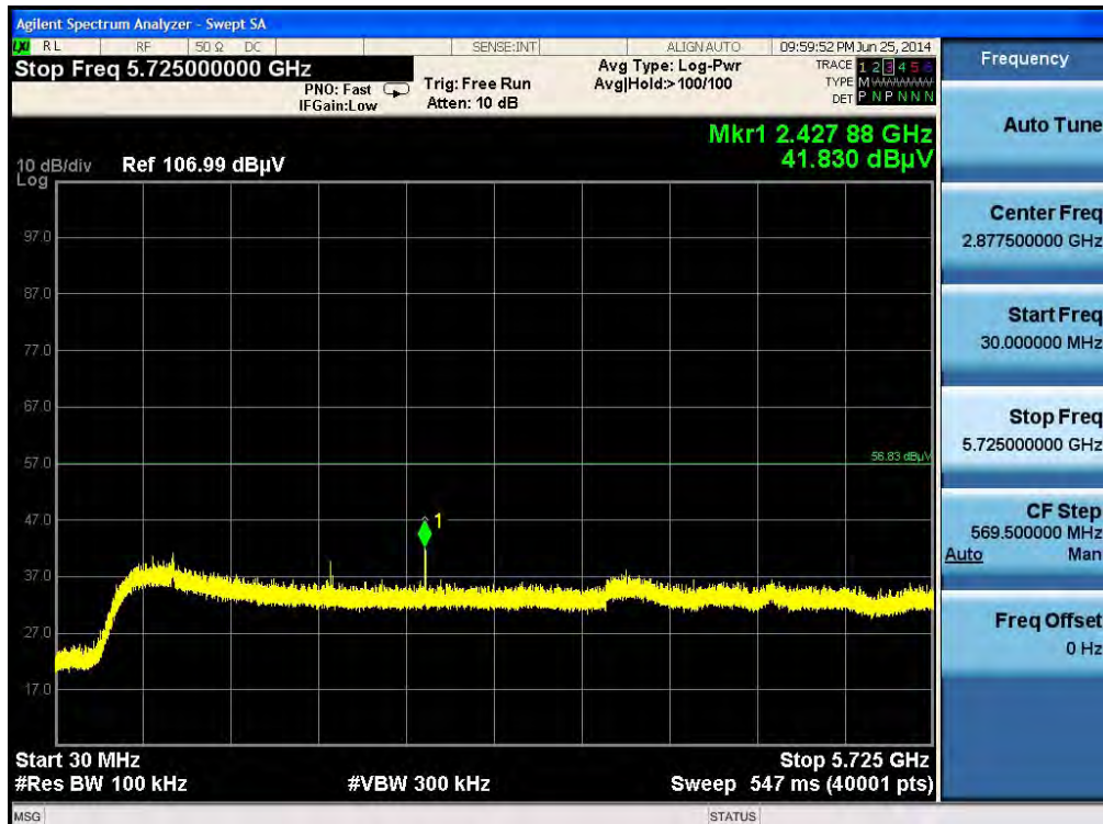
Plot on Configuration IEEE 802.11ac MCS0/Nss1 VHT20 / CH 165 / 30MHz~5725MHz (down 30dBc)
