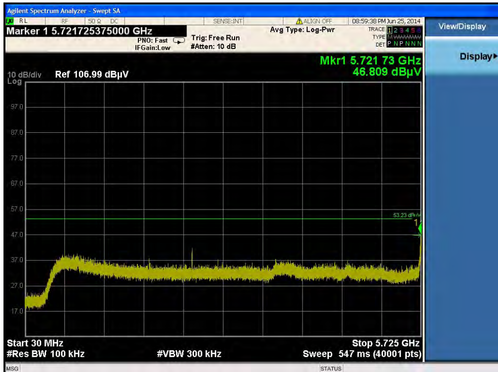
Plot on Configuration IEEE 802.11ac MCS0/Nss1 VHT40 / CH 159 / 30MHz~5725MHz (down 30dBc)
