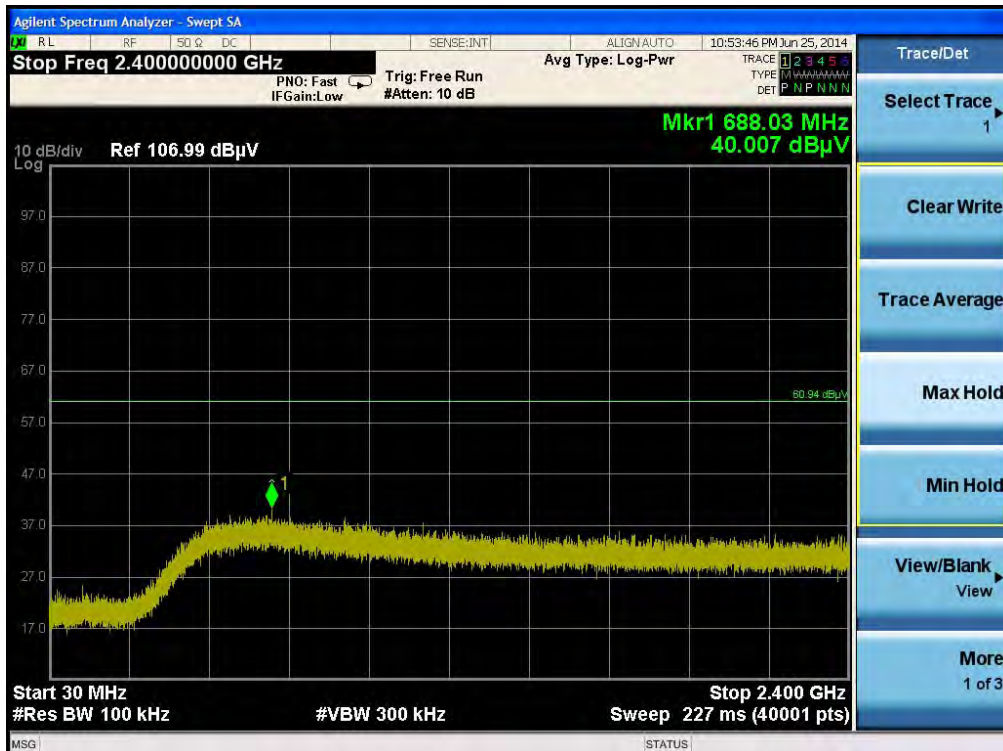
Plot on Configuration IEEE 802.11b / CH 11 / 30MHz~2400MHz (down 30dBc)
