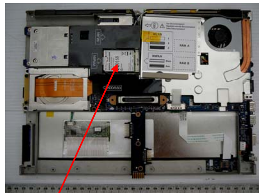
Embedded WWAN Module
