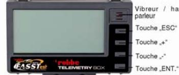
Pour charger également le boîtier télemétrique à l'extérieur, utilisez un adaptateur USB pour l'allume-cigares ou pour une prise de courant. N'utilisez que des chargeurs USB avec les caractéristiques suivantes 5V/ 1A.
