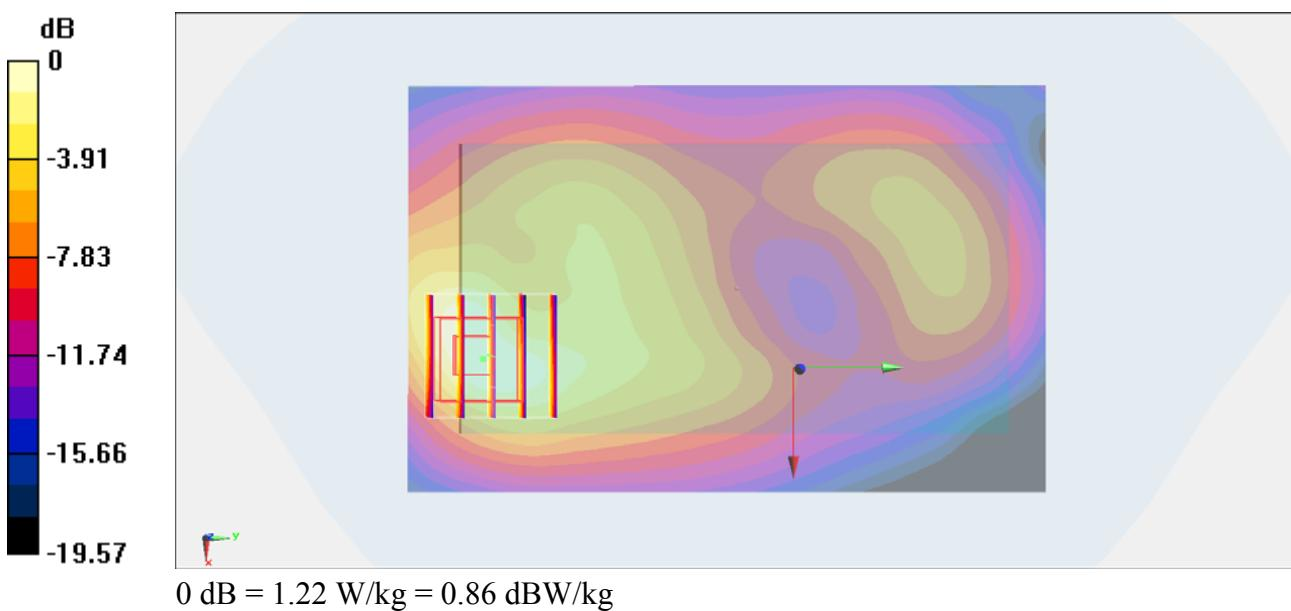
**#24\_GSM1900\_GPRS (4 Tx slots)\_Back\_1cm\_Ch661****DUT: 342505**
