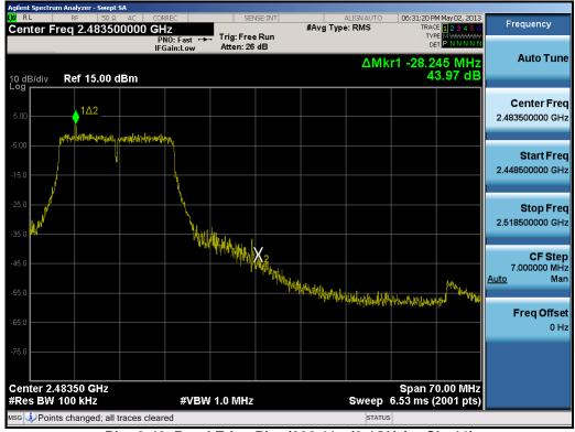
Plot 6-42. Band Edge Plot (802.11n (2.4GHz) - Ch. 11)
