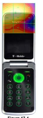
Figure 17-4 E-Field WD Scan overlay
