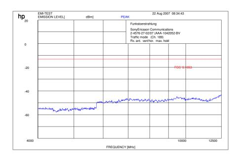
f < 1 GHz : RBW/VBW : 100 kHz  $f \ge 1 \text{GHz} : \text{RBW / VBW 1 MHz}$
