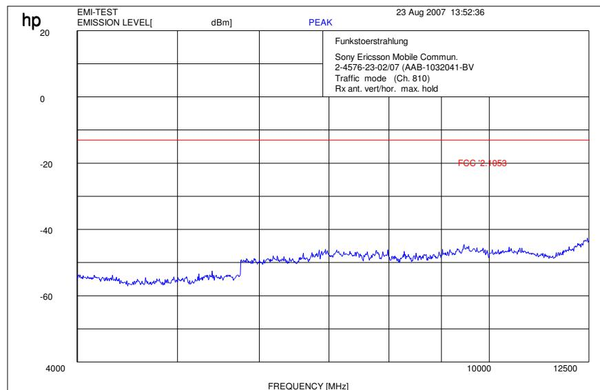
$f \geq 1 \text{ GHz}$  : RBW / VBW 1 MHz
