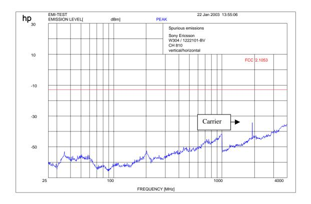
$f < 1 \; GHz : RBW/VBW : 100 \; kHz \qquad \qquad f \geq 1 GHz : RBW / VBW \; 1 \; MHz$
