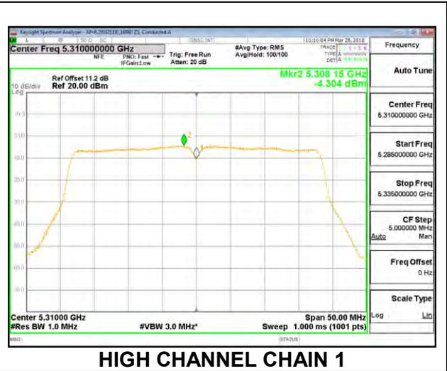
**8.5.8. 802.11ac VHT80 MODE IN THE 5.3 GHz BAND**
