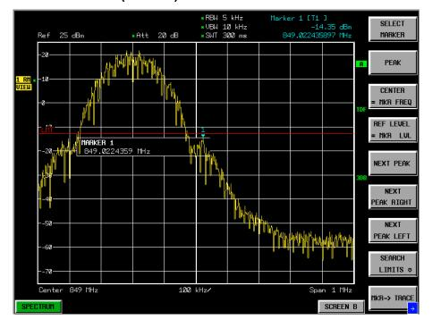
EGPRS 850-8PSK LOW BAND EDGE BLOCK-A (GSM850)-Channel 128
