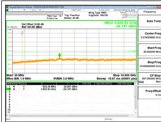
5G NR n5 15MHz QPSK LOW Ch RB1-0
