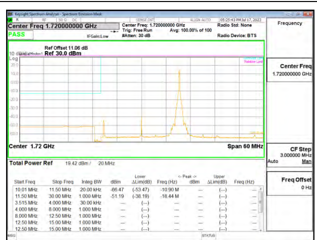
5G NR N66 20MHz QPSK LOW Ch RB1-104
