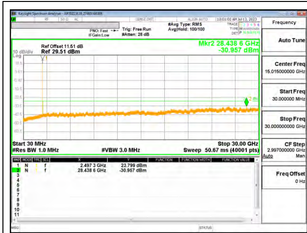
5G NR n41 40MHz QPSK LOW Ch RB1-0
