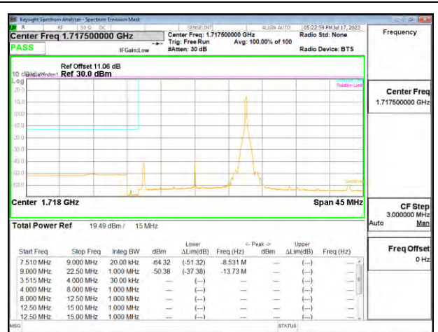
5G NR N66 15MHz QPSK LOW Ch RB1-77
