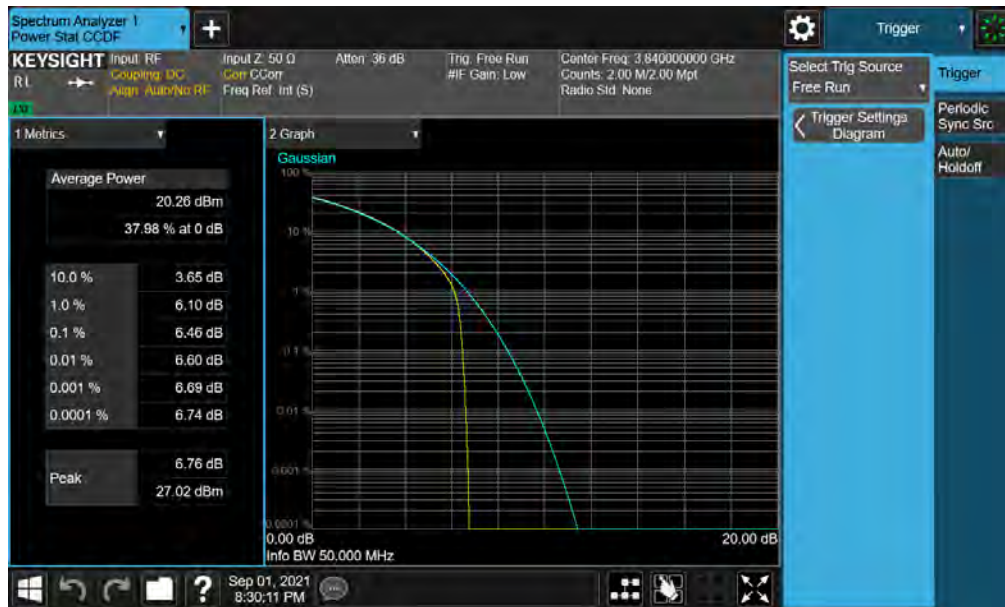
Plot 7-70. PAR Plot (NR Band n77 - 50MHz CP-OFDM QPSK - Full RB )
