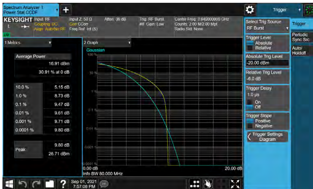
Plot 7-62. PAR Plot (NR Band n77 - 80MHz CP-OFDM QPSK - Full RB )
