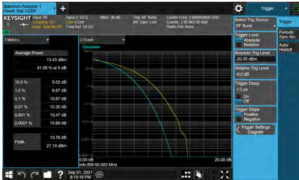
Plot 7-68. PAR Plot (NR Band n77 - 60MHz CP-OFDM 256-QAM - Full RB )
