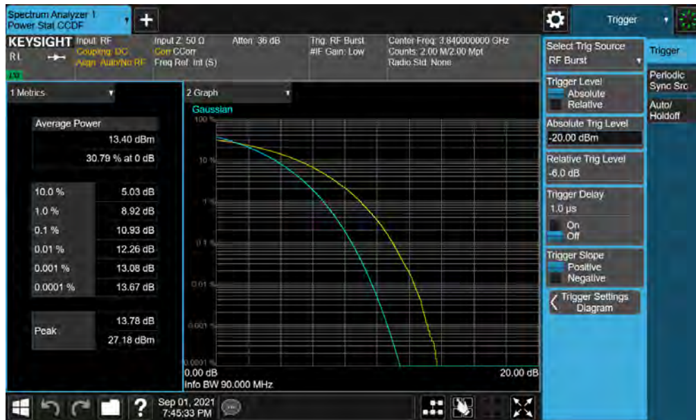
Plot 7-60. PAR Plot (NR Band n77 - 90MHz CP-OFDM 256-QAM - Full RB )
