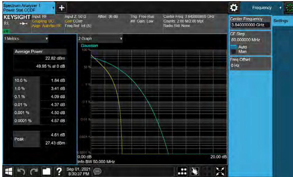
Plot 7-69. PAR Plot (NR Band n77 - 50MHz DFT-s-OFDM BPSK - Full RB )
