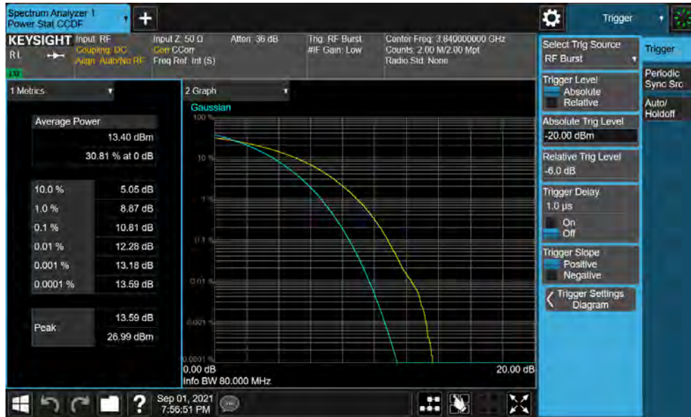
Plot 7-63. PAR Plot (NR Band n77 - 80MHz CP-OFDM 256-QAM - Full RB )
