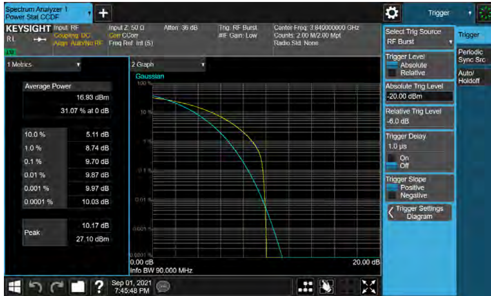
Plot 7-59. PAR Plot (NR Band n77 - 90MHz CP-OFDM QPSK - Full RB )
