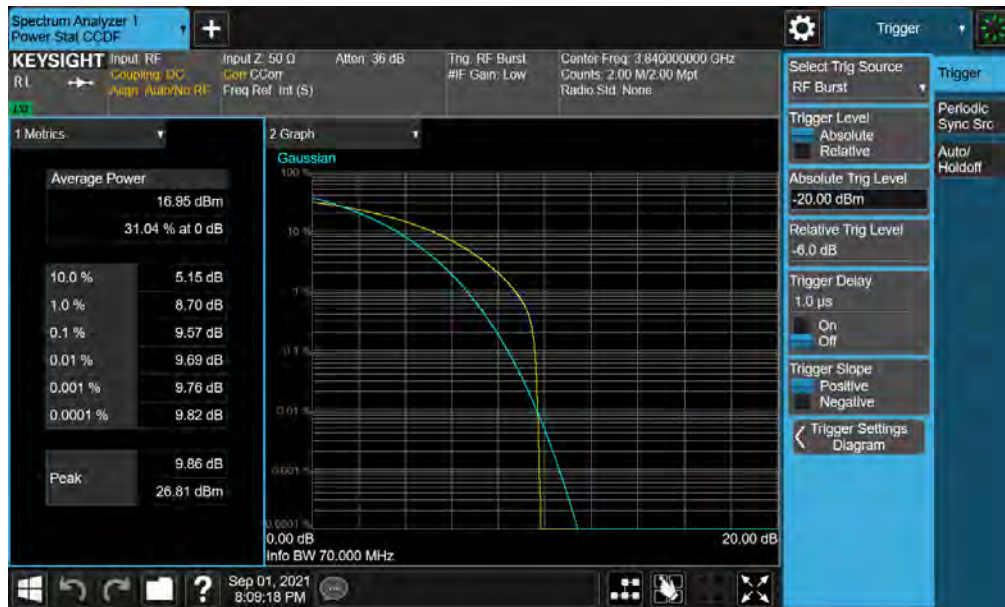
Plot 7-64. PAR Plot (NR Band n77 - 70MHz CP-OFDM QPSK - Full RB )
