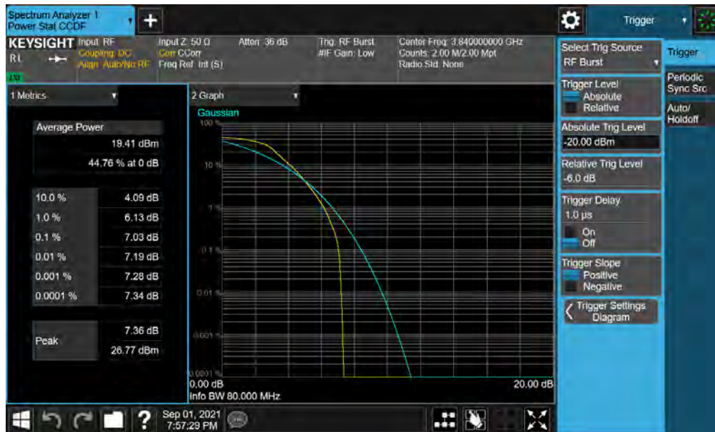
Plot 7-61. PAR Plot (NR Band n77 - 80MHz DFT-s-OFDM BPSK - Full RB )
