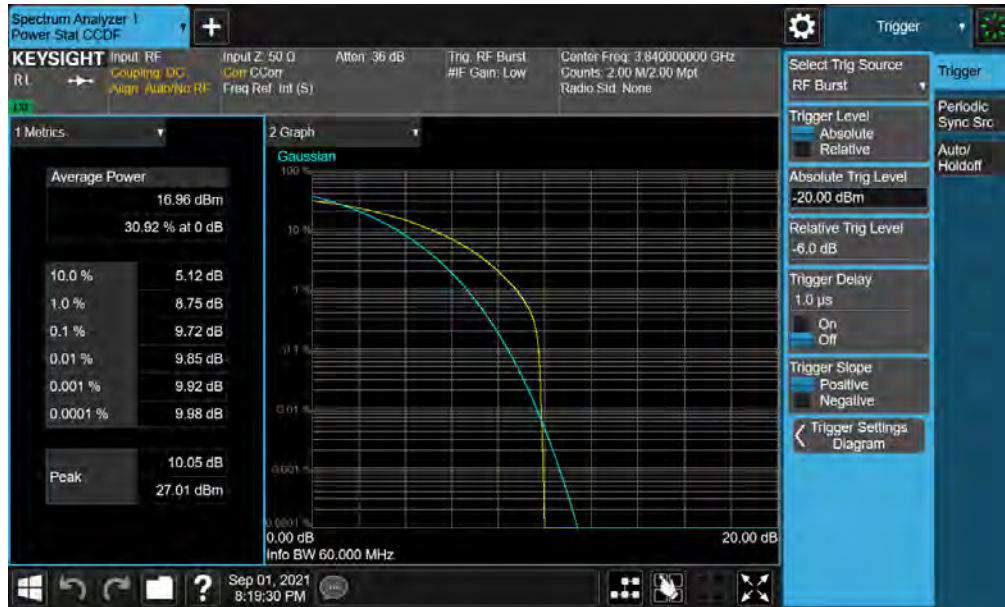
Plot 7-67. PAR Plot (NR Band n77 - 60MHz CP-OFDM QPSK - Full RB )
