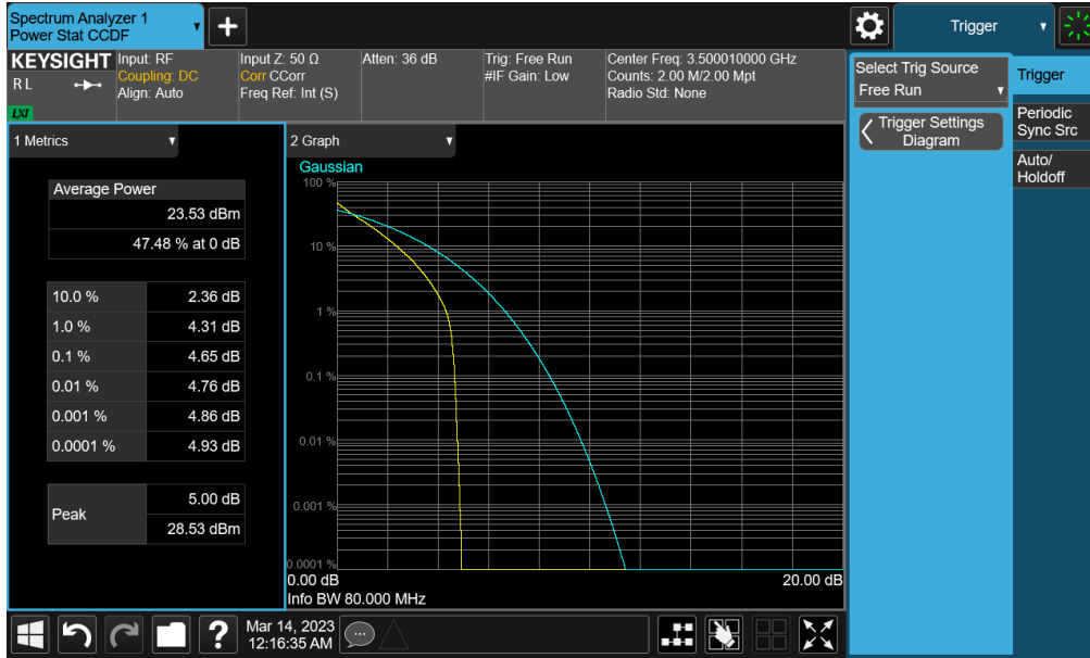
Plot 7-287. PAR Plot (NR Band n77 PC2 (DoD) - 80MHz CP-OFDM QPSK - Full RB - Sub-UHB)
