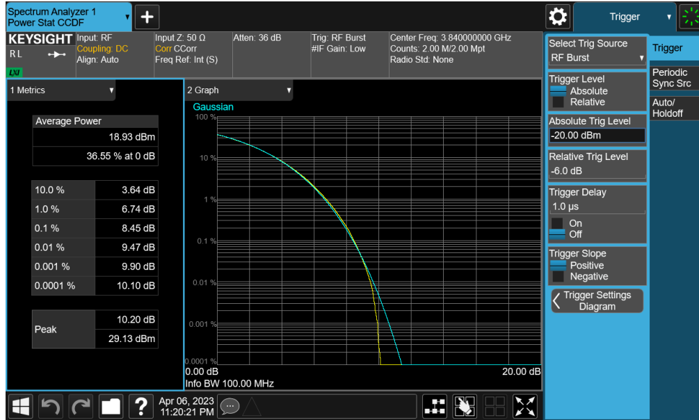
Plot 7-303. PAR Plot (NR Band n77 PC2 (C-band) - 100MHz CP-OFDM 256-QAM - Full RB - Main1)
