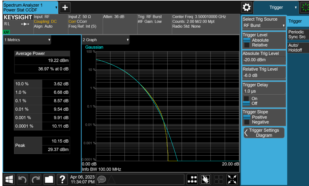
Plot 7-267. PAR Plot (NR Band n77 PC2 (DoD) - 100MHz CP-OFDM 256-QAM - Full RB - Main1)
