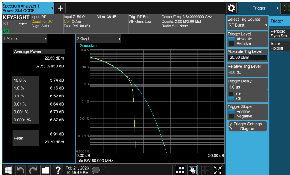
Plot 7-308. PAR Plot (NR Band n77 PC2 (C-band) - 60MHz CP-OFDM QPSK - Full RB - Main1)
