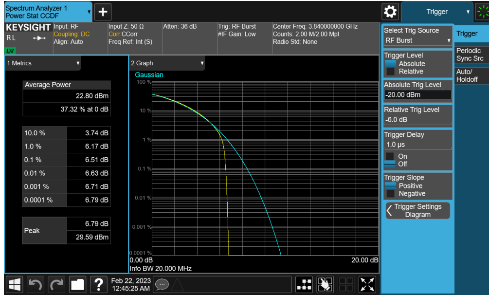
Plot 7-317. PAR Plot (NR Band n77 PC2 (C-band) - 20MHz CP-OFDM QPSK - Full RB - Main1)
