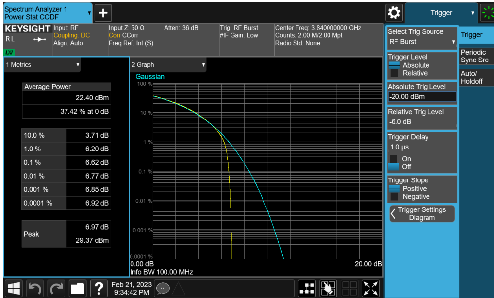
Plot 7-302. PAR Plot (NR Band n77 PC2 (C-band) - 100MHz CP-OFDM QPSK - Full RB - Main1)
