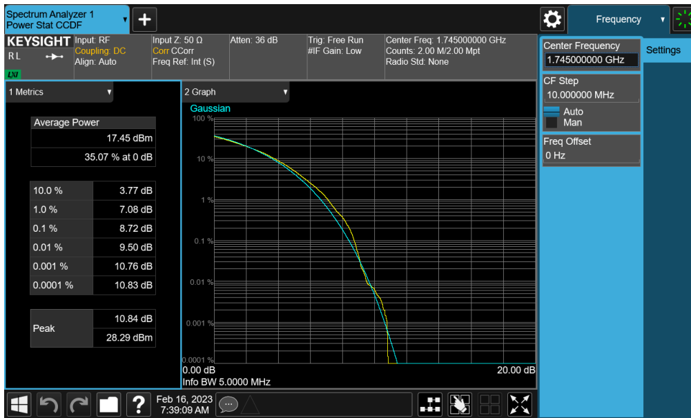
Plot 7-316. PAR Plot (NR Band n66 - 5MHz CP-OFDM 256-QAM - Full RB – Main2)
