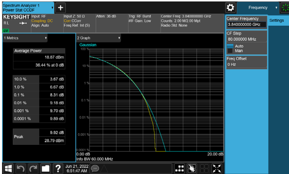
Plot 7-147. PAR Plot (NR Band n77 - 60MHz CP-OFDM 256-QAM - Full RB - As-Div ANT)
