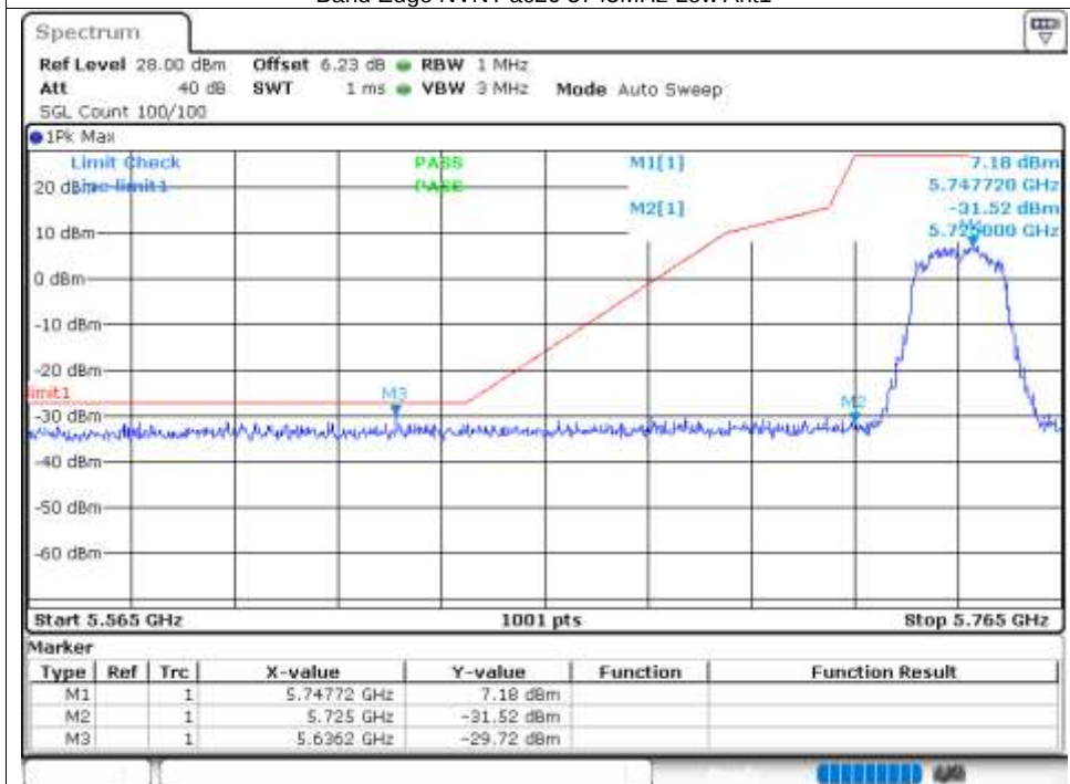
Band Edge NVNT ac20 5825MHz High Ant1
