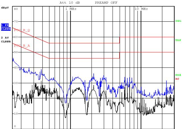
150 kHz  $$\rm 30~MHz$$  Model Name : SG-1010W/ALL  $120~\rm Vac~60~Hz$  Phase : Neutral
