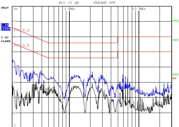
150 kHz 30 MHz Model Name : SG-1010W/ALL 120 Vac 60 Hz Phase : Live
