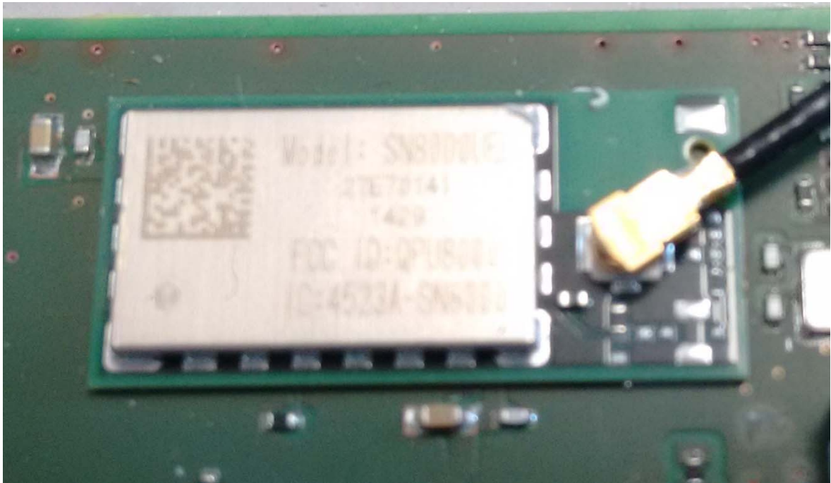
WI-FI Module (FCC ID: QPU8000)
