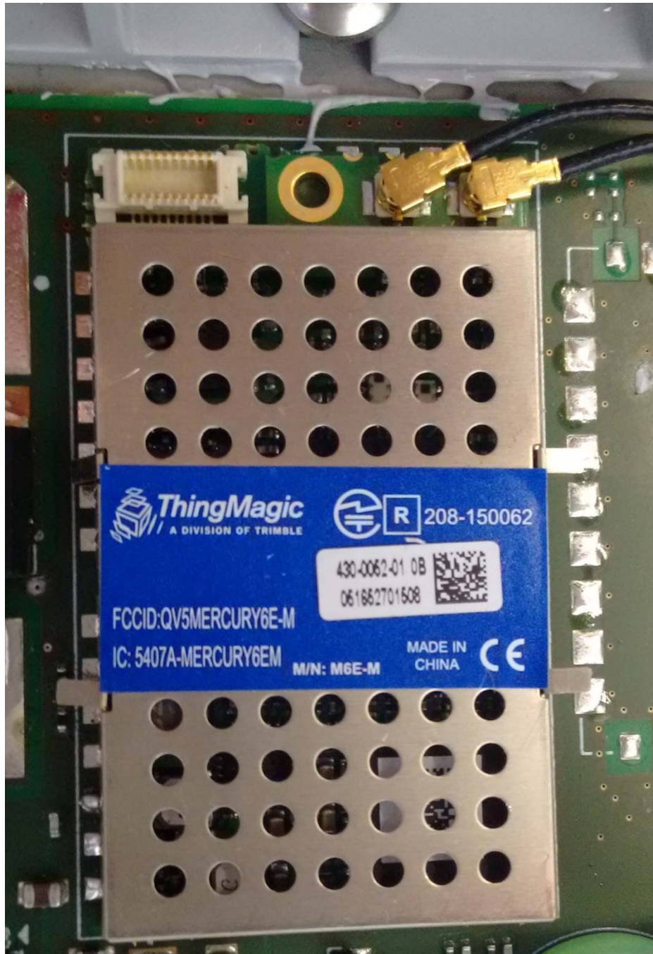
RFID Module (FCC ID: QV5MERCURY6E-M)
