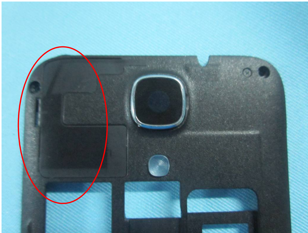
Bluetooth / BLE / WIFI Antenna View
