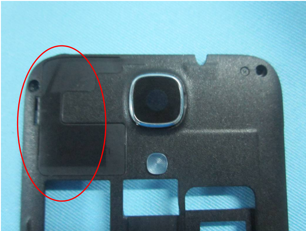
Bluetooth / BLE / WIFI Antenna View
