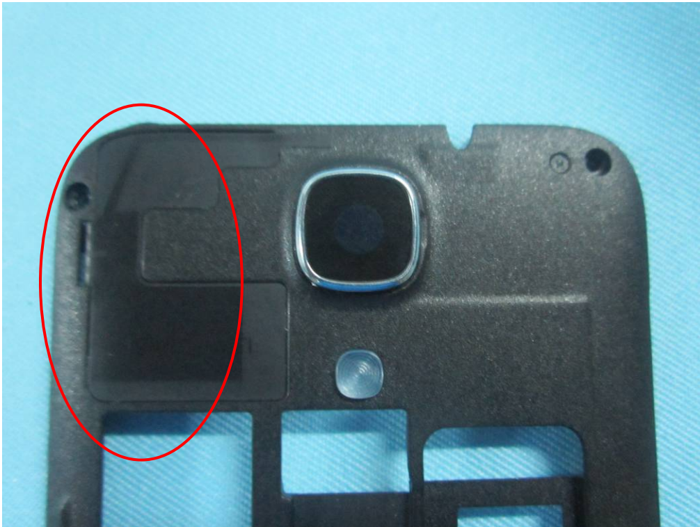
Bluetooth / BLE / WIFI Antenna View
