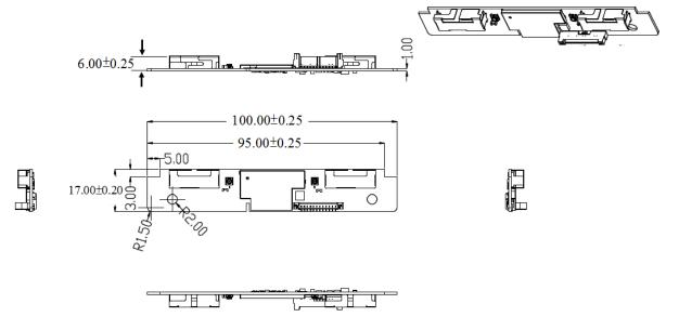
Unit:mm Tolerance: ±0.10mm
