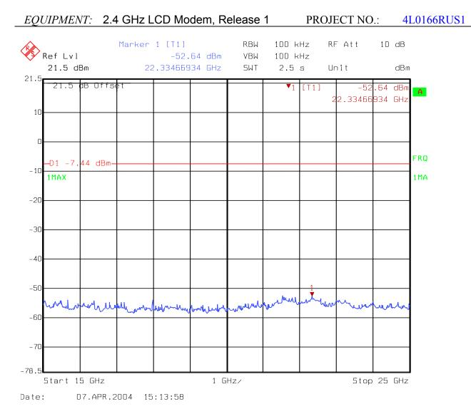
DIRECT SEQUENCE SPREAD SPECTRUM TRANSMITTER
