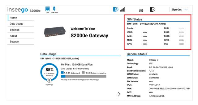
**Carrier:** The name of the Mobile Network Operator.
