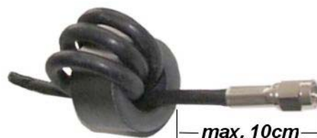
Bild 7: Montage des Ringkerns auf der Antennenzuleitung
