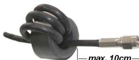
Bild 3: Montage des Ringkerns auf der Antennenzuleitung
