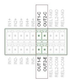
Fig. 15: Optocoupler -Outputs OUT1-2
