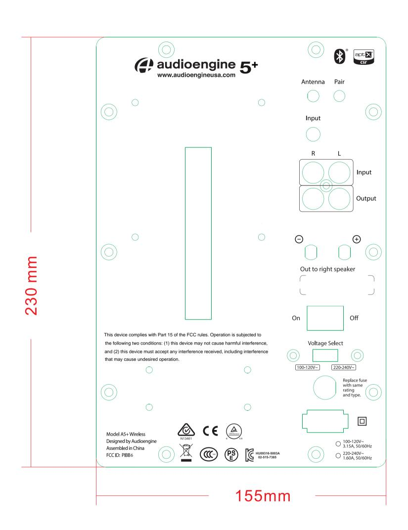
系统规格:冷轧板,230\*155\*T2.0mm,烤黑蒙漆,丝印J-427C,
