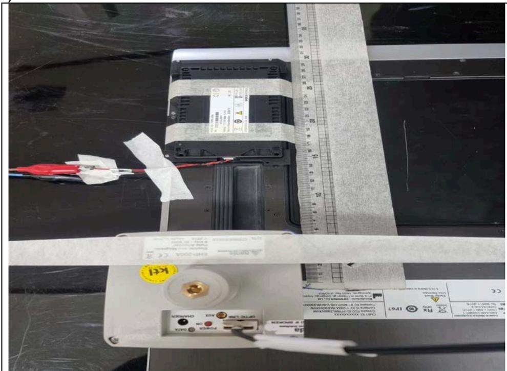
**Test mode : IC MPE (Distance : 20 cm)**
