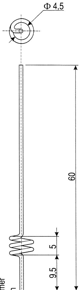
Matériau : Acier ressort diamètre 1mm
