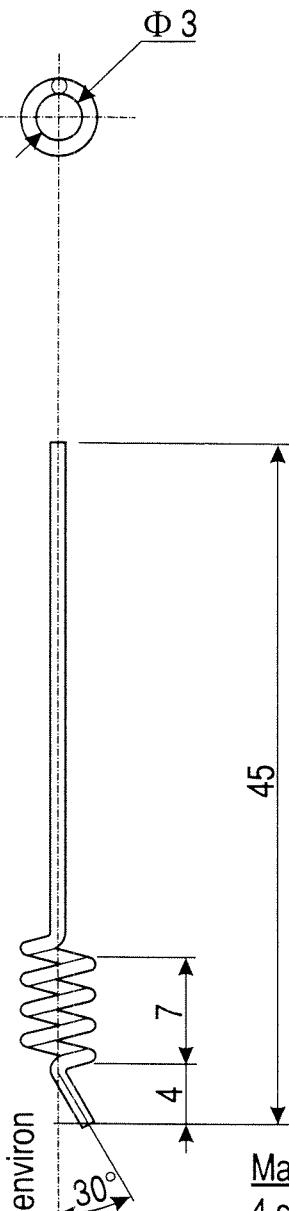
Matériau : Acier ressort diamètre 1mm
