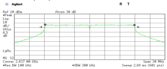
Occupied Bandwidth 17.7283 MHz **Осс ВМ % Рыг** 99.00 % **х dB** -6.00 dB
