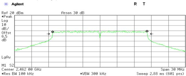
Occupied Bandwidth 16.5148 MHz Осс ВW % Рыг 99.00 % х dB -6.00 dB
