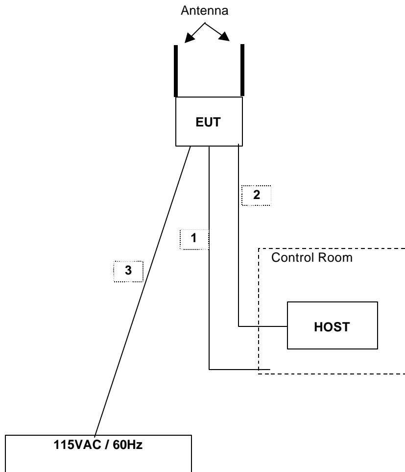
**SETUP BELOW 1 GHz TEST**
