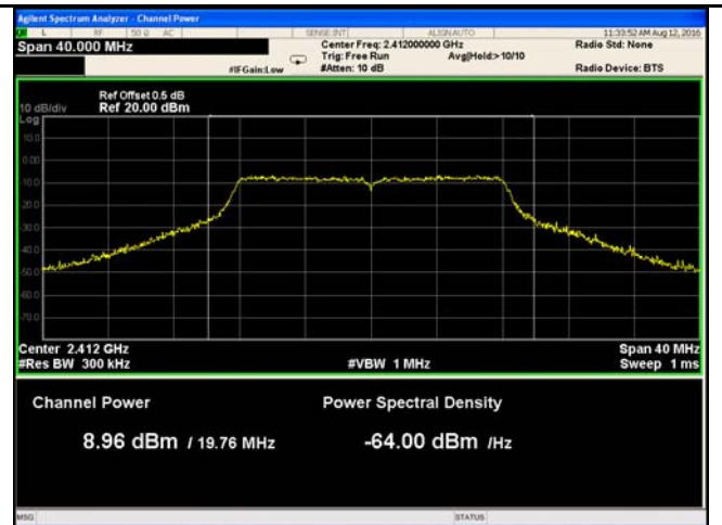
802.11g - AV Output power - Low CH 2412
