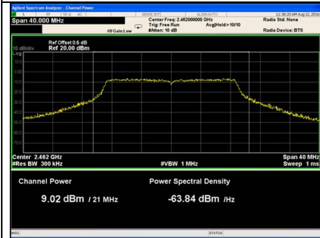
802.11n20 - AV Output power - High CH 2462
