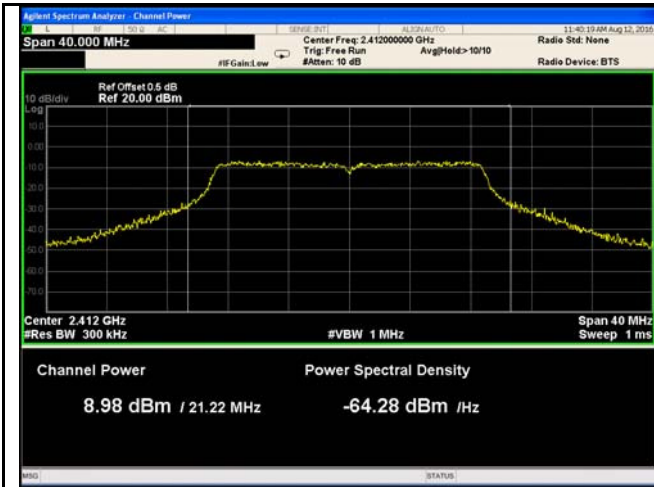
802.11n20 - AV Output power - Low CH 2412
