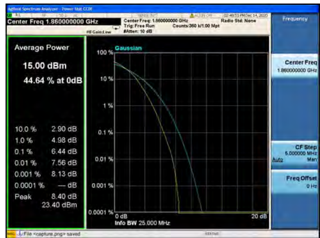
Band2 / 20MHz / Low CH / 64QAM
