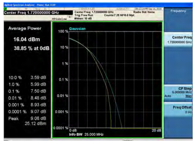
Band66 / 20MHz / Low CH / 64QAM
