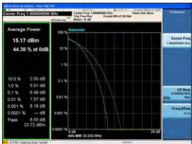
Band2 / 20MHz / High CH / 16QAM
