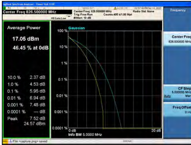
Band5 / 5MHz / Low CH / 64QAM
