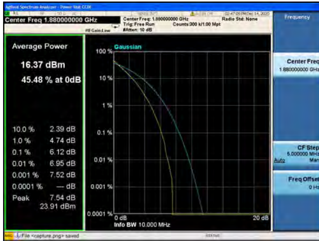
Band2 / 10MHz / Mid CH / 64QAM
