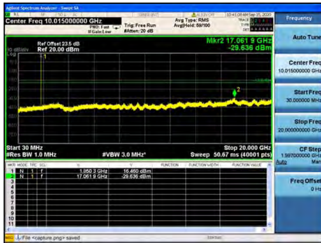
Band2 / 1.4MHz / Low CH / 64QAM
