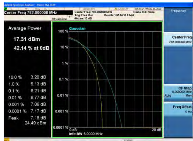
Band13 / 10MHz / Mid CH / 64QAM
