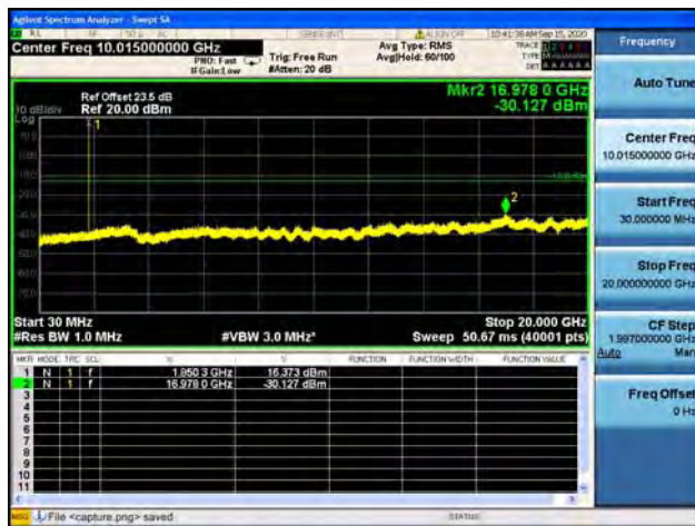
Band2 / 1.4MHz / Mid CH / 16QAM
