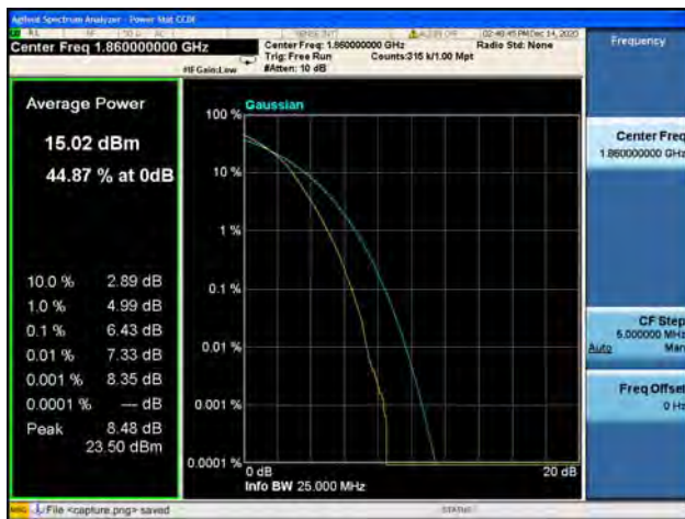
Band2 / 20MHz / Low CH / 16QAM
