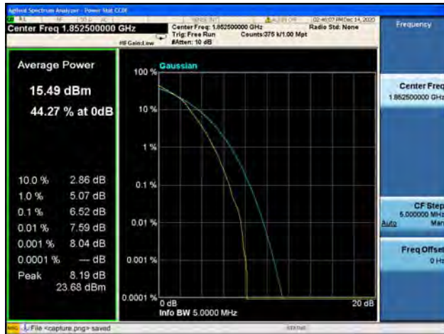
Band2 / 5MHz / Mid CH / 16QAM
