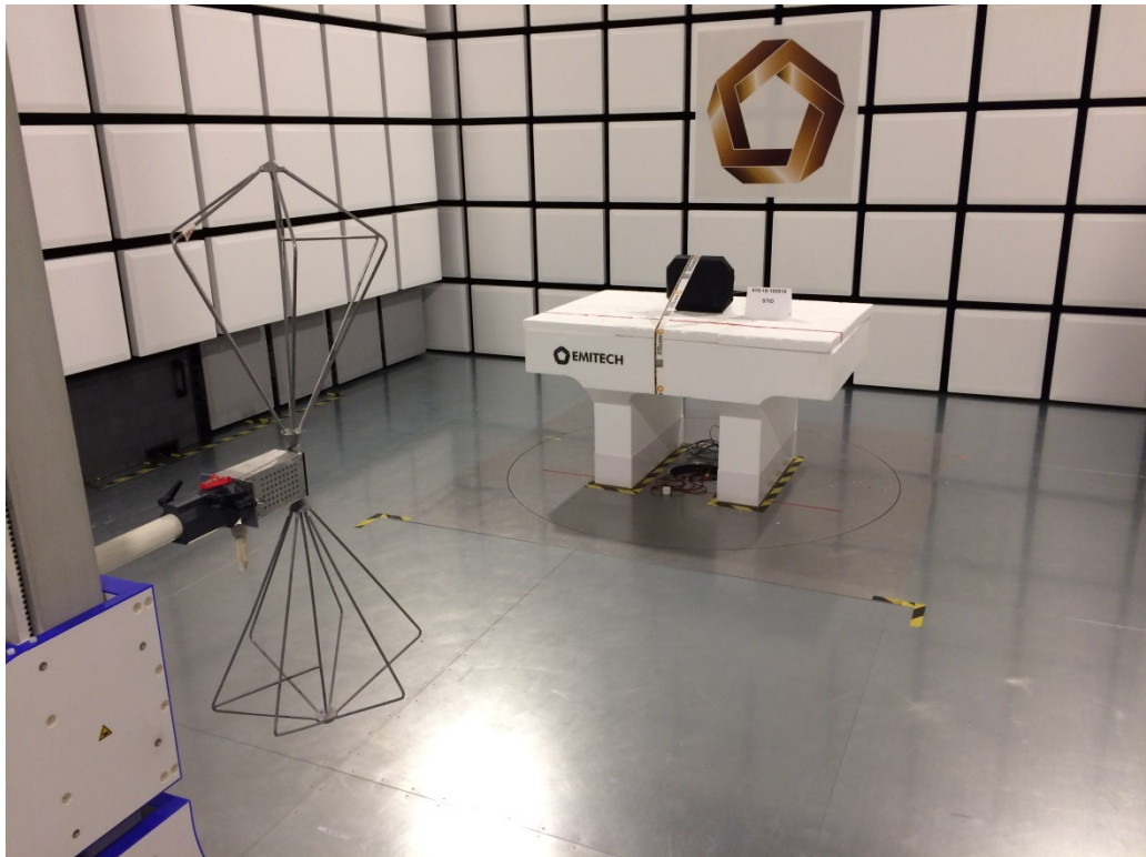
TEST SETUP PHOTO(S) - 30\text{MHz} < F < 200\text{MHz}
