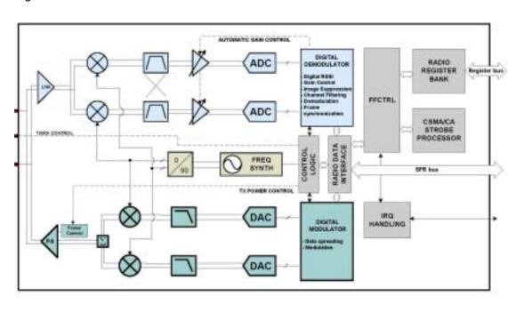
Figure 2 : CC2430 Radio Module
