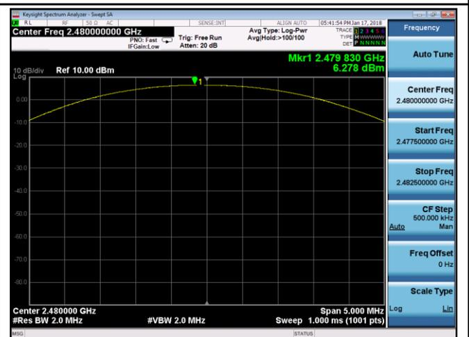
$\pi/4$  DQPSK Output power - High CH 2480
