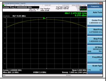
$\pi$  /4 DQPSK Output power - Mid CH 2441
