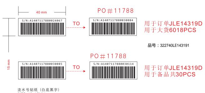
流水号贴纸(白底黑字) SIZE:40\*15MM 格式:Code 39 单机数量:2PCS,贴于机器后板和彩盒底部
