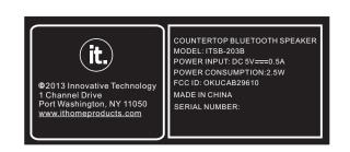
RATING label SIZE: 72\*30 MM PRINTED IN WHITE ON BLACK BACKGROUND QTY=1PC 后壳铭版 贴纸 尺寸: 72\*30 MM 黑底白字 用量: 1PC 贴机器后板 品号:32277723000101
