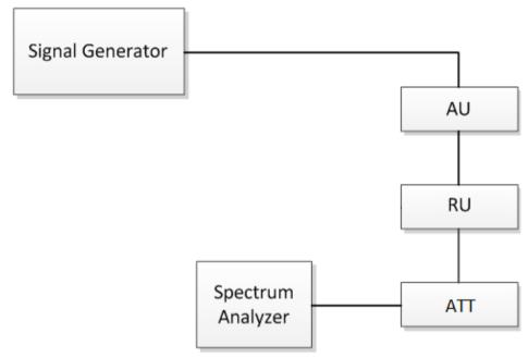
Fig.3. Band edge test configuration
