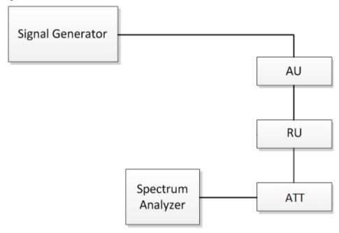
Fig.3. Band edge test configuration
